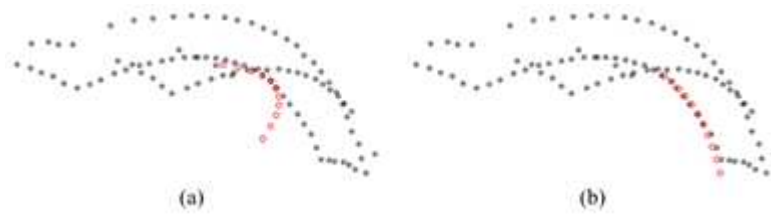
図 4. 軌跡モデルの最適化. 図中の黒い円は検出されたボール候補, 赤い円は軌跡モデルより推定されたボール位置であり, (a)は最適化前, (b)は3回最適化を繰り返した後の軌跡モデルを示している.
