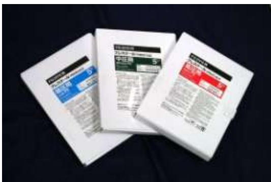
図 6：フィルムセンサによる衝撃分散能の測定（左：各種フィルムセンサ、右：圧力画像解析システム）
