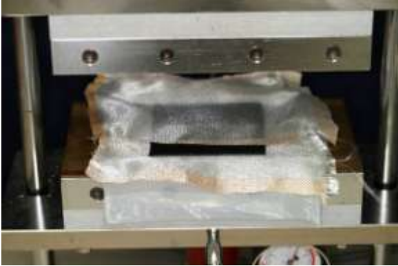
図 2 : ガラス繊維クロス強化型熱可塑性樹脂の試作
