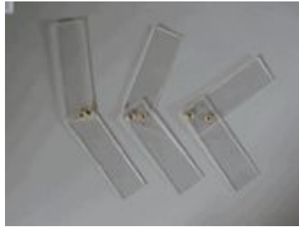
図 5. 実験 2 において用いた 30^{\circ} , 60^{\circ} , 90^{\circ} それぞれの角度に合わせた角度計 (左から 30^{\circ} , 60^{\circ} , 90^{\circ} )
