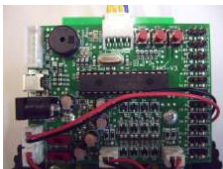
写真1. 11軸制御可能な制御基盤の試作品
