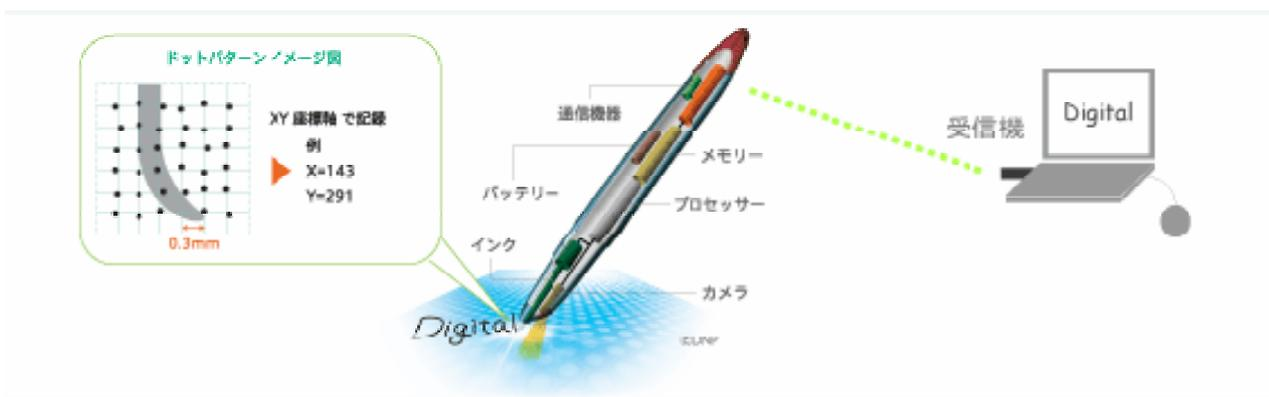
図 3-1 デジタルペンの仕組み概念図(株式会社ワオネット HP より)
