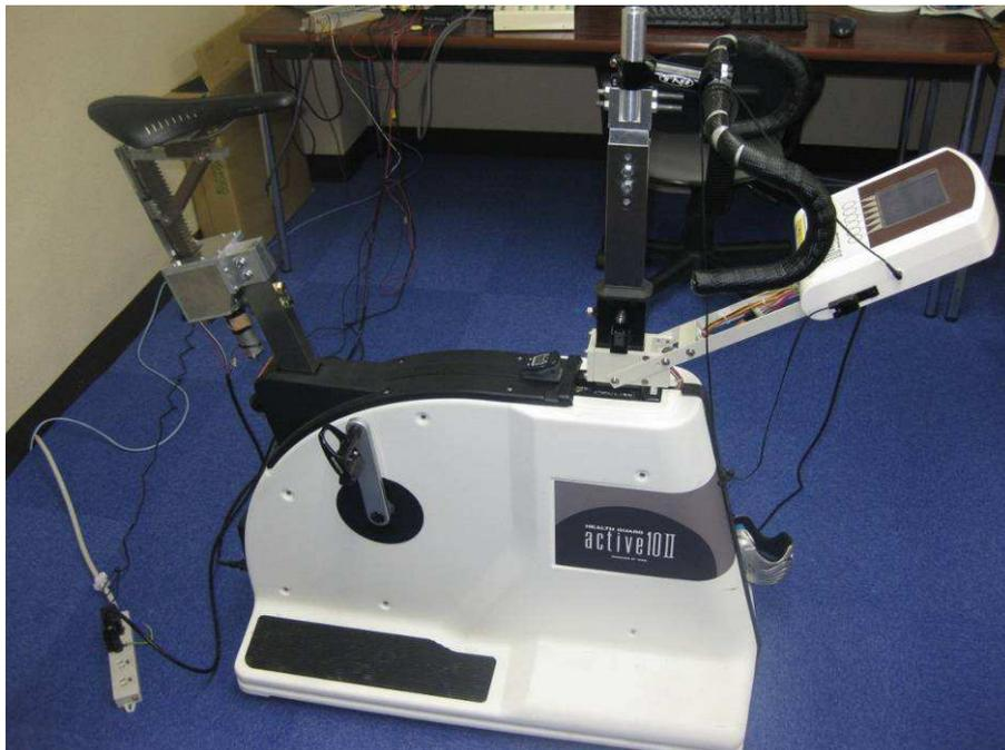
図 4 サドル高さ自動調整装置の外観図
